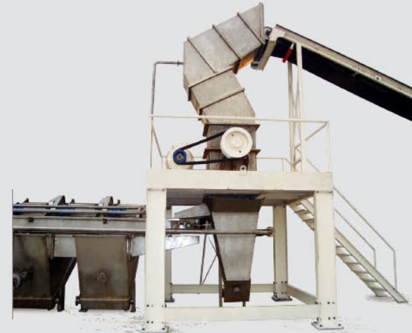
Akü Kırma Ünitesi / Battery Breaking Unit
