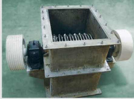
Akü Kırma Ünitesi / Battery Breaking Unit
